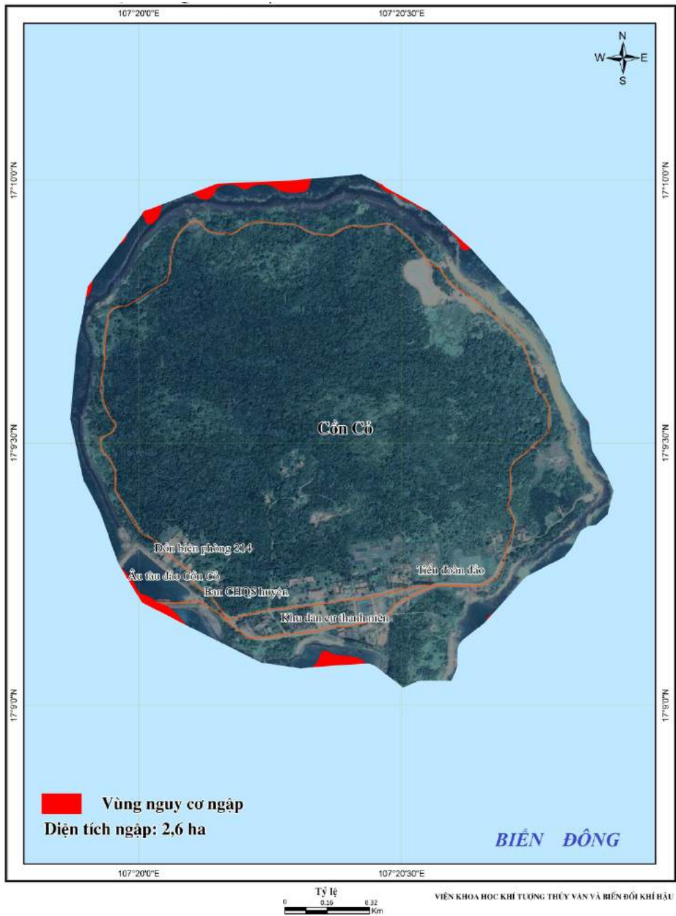
Hình B41. Bản đồ nguy cơ ngập ứng với mực nước biển dâng 100 cm, đảo Cồn Cỏ, tỉnh Quảng Trị
